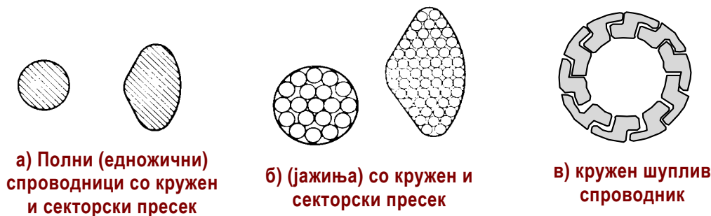
Слика 2.3 Форми и начини на изведба на спроводниците кај енергетските кабли
