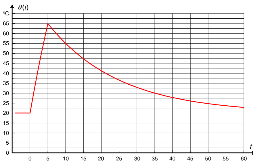
Слика 10.1. Зависност \theta(t) на температурата на кабелот од времето
