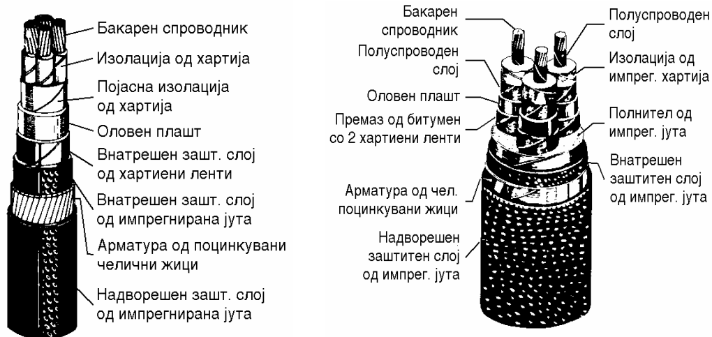
Слика. Класични кабли со изолација од импрегнирана хартија ( IP): четирижилен, за нисок напон (1 kV) лево и 35 kV трижилен кабел
