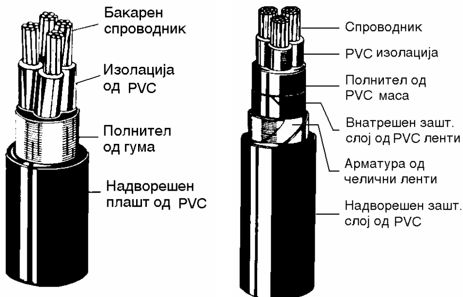
Слика. Кабли со изолација од PVC: четирижилен, за нисок напон (1 kV) лево и 10 kV трижилен кабел
