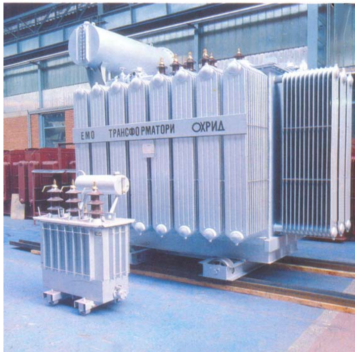
Слика 2.18. Енергетски трансформатори 50 kVA и 8.000 kVA
