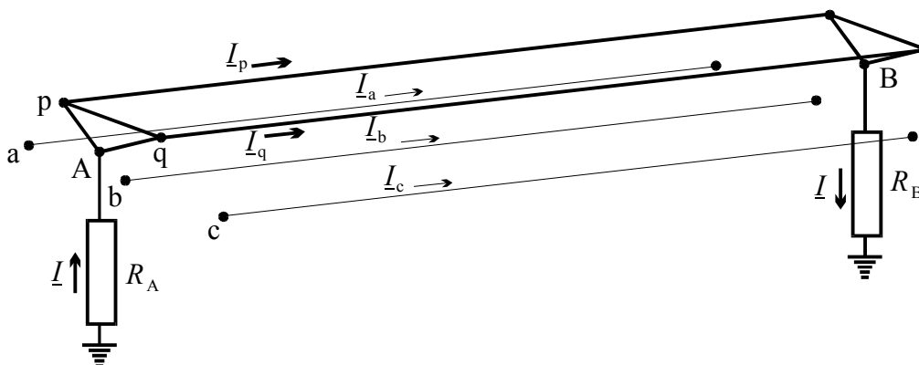
Слика 3.24. Модел на трифазен вод за пресметка на загубите на моќност во заштитните јажиња
